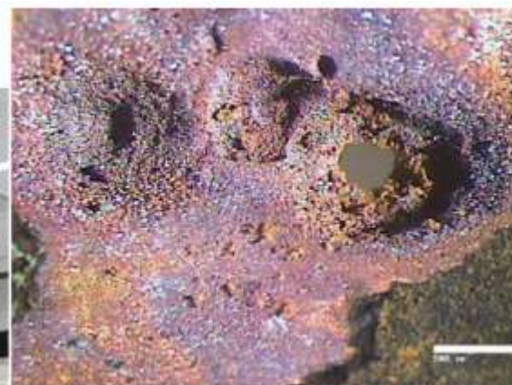
Insidan av ett perforerat kopparrör i ett slutet klimatsystem.
