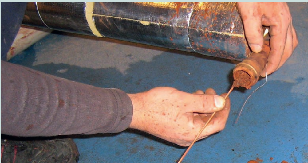
Rör som ser ut så här på insidan tappar sin funktion, vilket påverkar systemets effektivitet. Foto: Chemiclean
